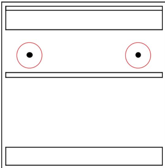
2 Bohrungen in Rückwand
